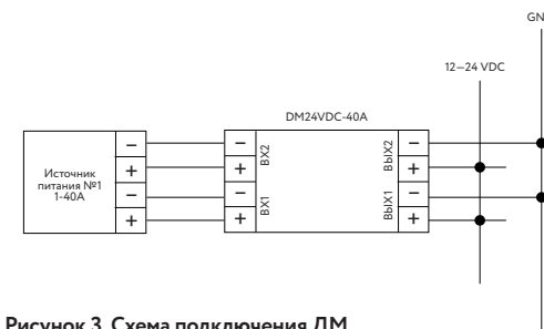
Рисунок 3. Схема подключения ДМ
