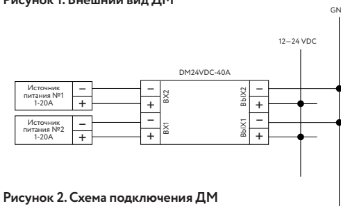
Рисунок 2. Схема подключения ДМ
