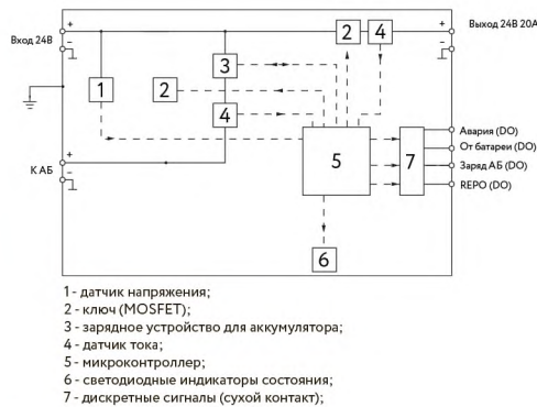
Рисунок 2. Структурная схема ИБП
